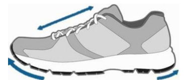
Figur 3. En "walkingsko" är rundad vid tårna och vid hälen
